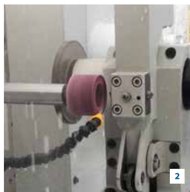
2 Internal grinding wheel dresser with single point diamond Orovnávač kotouče pro vnitřní broušení s jedním diamantovým hrotem
