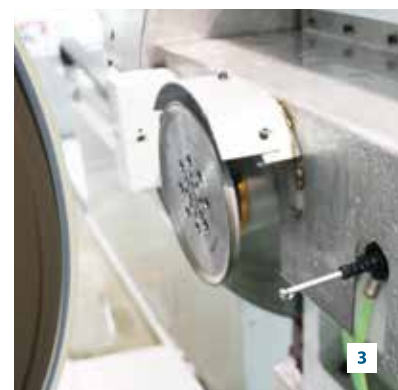
2 Internal grinding wheel dresser with single point diamond Orovnávač kotouče pro vnitřní broušení s jedním diamantovým hrotem
