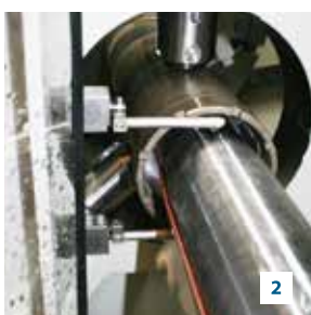
1 Absolute in-process measuring device Přístroj pro přímé měření během obrábění
